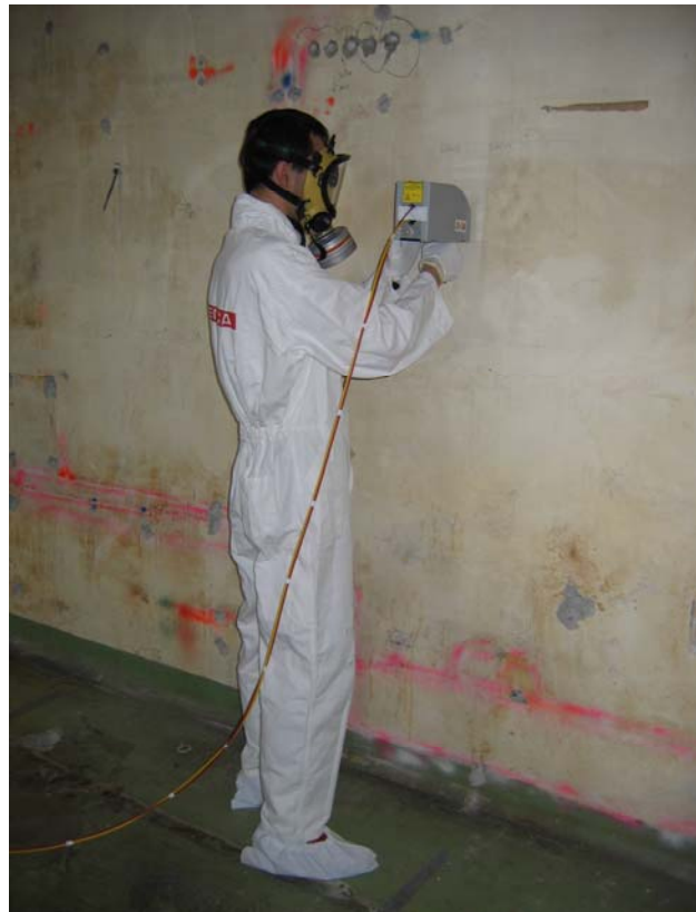
Analyse par LIBS de contamination d'uranium – installation ATUE CEA-CAD
